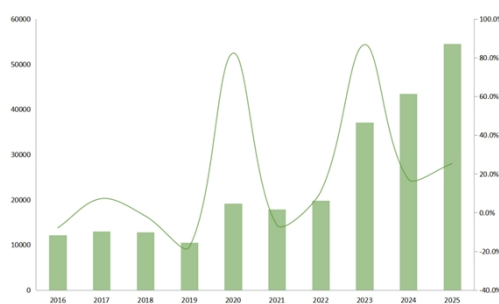
图 12 2016—2025 年全国新增电力装机及增速情况（单位：万千瓦）
